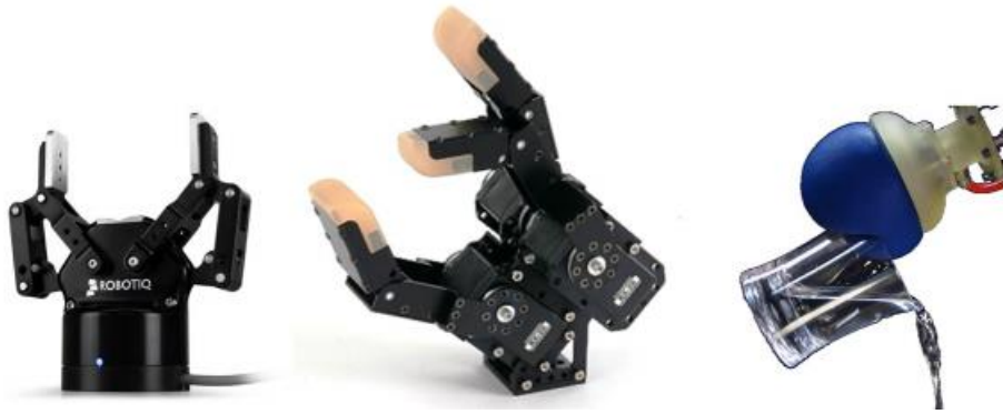
Рис. 200 Види затискачів (зліва направо: ROBOTIQ, ROBOTIS, Cornell University)
