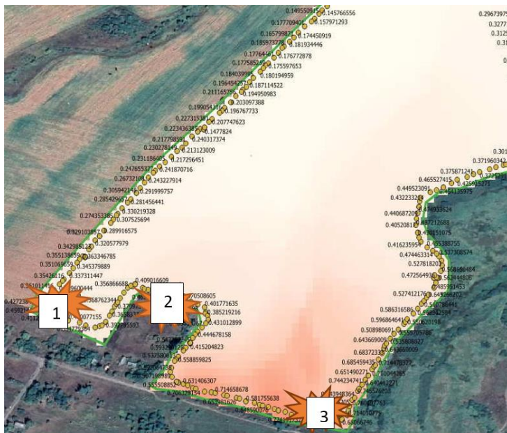
Рис. 4. Радиологічне обстеження 1-го полігону з визначенням еквівалентної дози.
