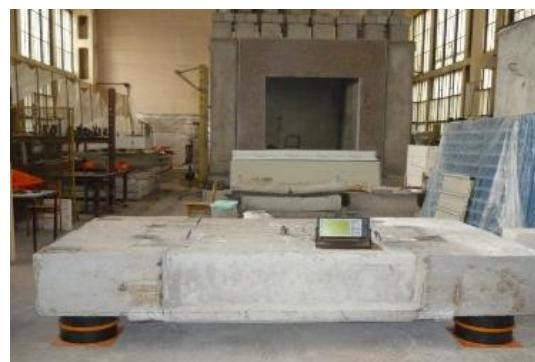
Рисунок 2 – Динамічні випробування системи сеймоізоляції (визначення фактичної жорсткості та демпфування гумових сеймоопор) [2]
