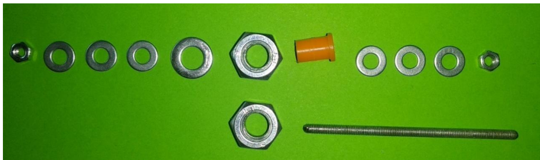
Рис. 2. Складові і порядок складання універсального елемента конструкції
