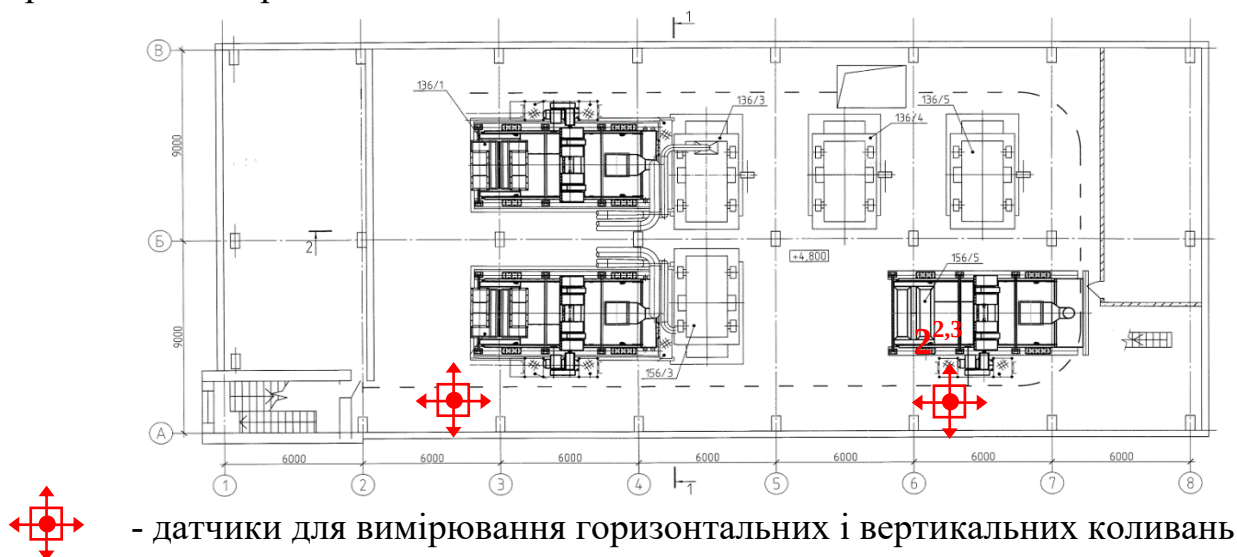
Рис. 3. Розстановка датчиків (акселерометрів) на відм. +4.800 біля грохотів
