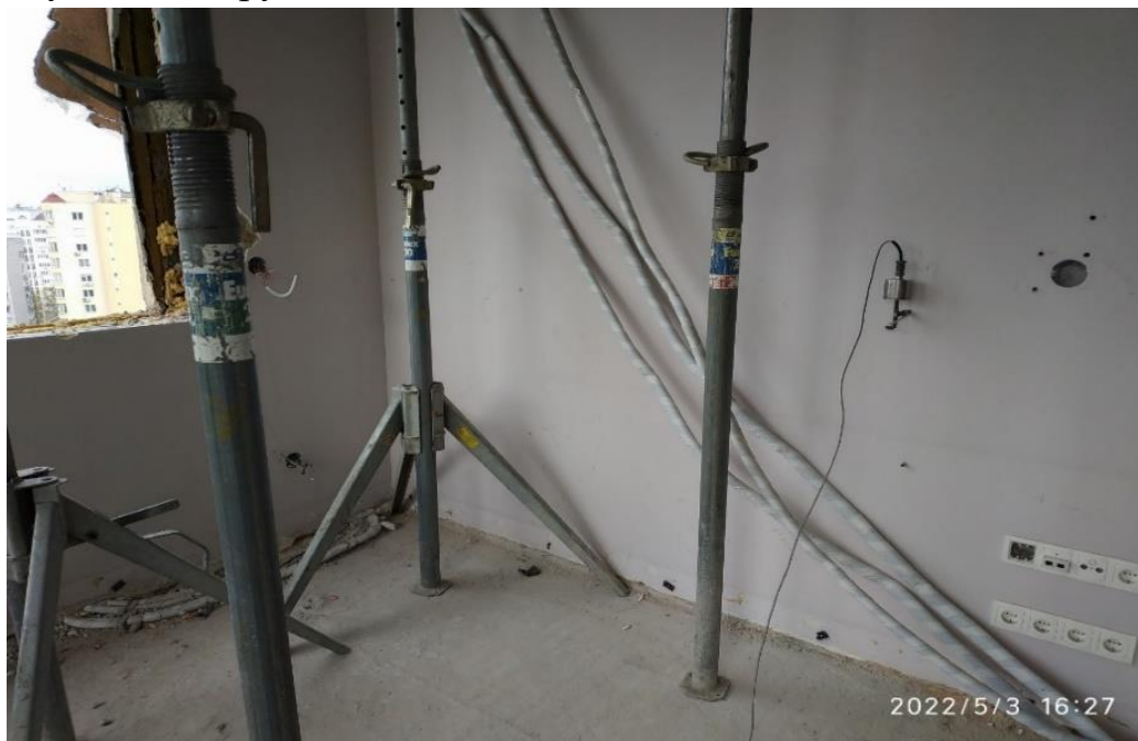
Рисунок 2 – Закріплення акселерометра до монолітної діафрагми на 20 поверсі будинку (вісь 5/І) під час проведення вібраційної діагностики в травні 2022 р.
