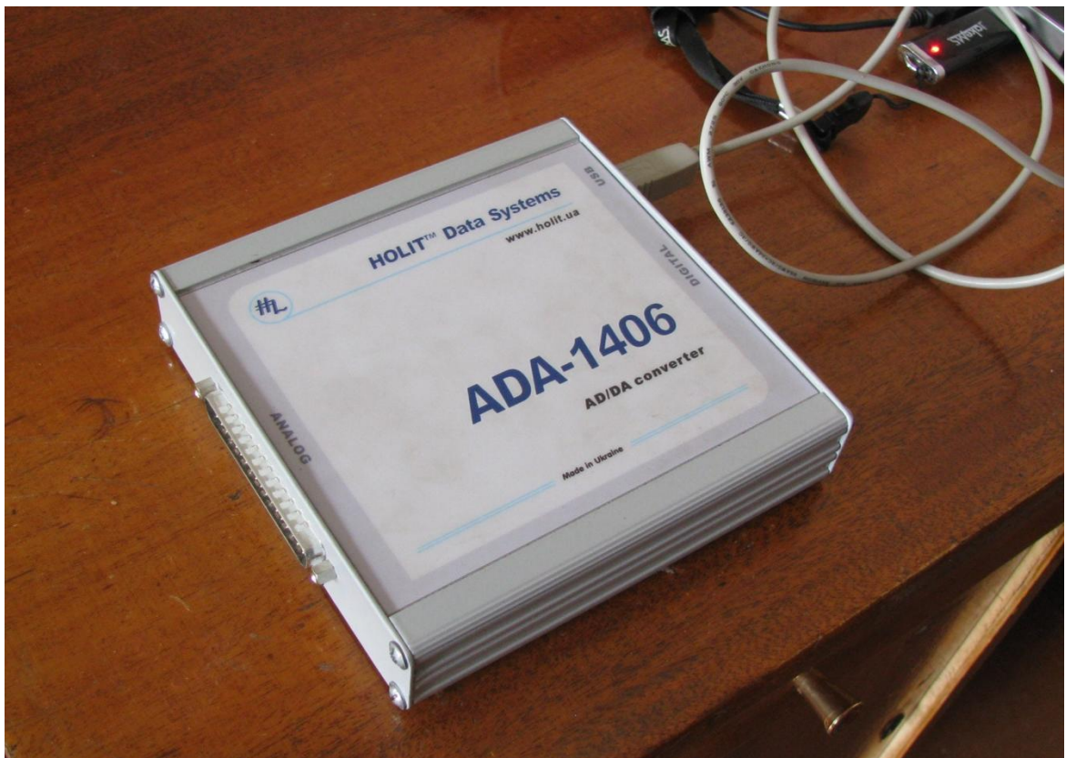
Рис. 6.5. Зовнішній вигляд АЦП ADA-1406
