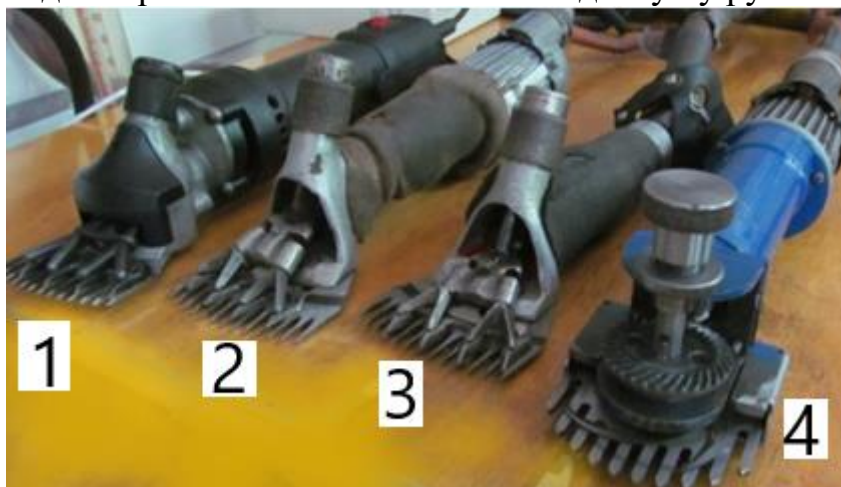
Рис. 1. Стригальні машинки 1, 2, 3 - зворотно-поступальний різальний апарат, 4 - ротаційний різальний апарат.
