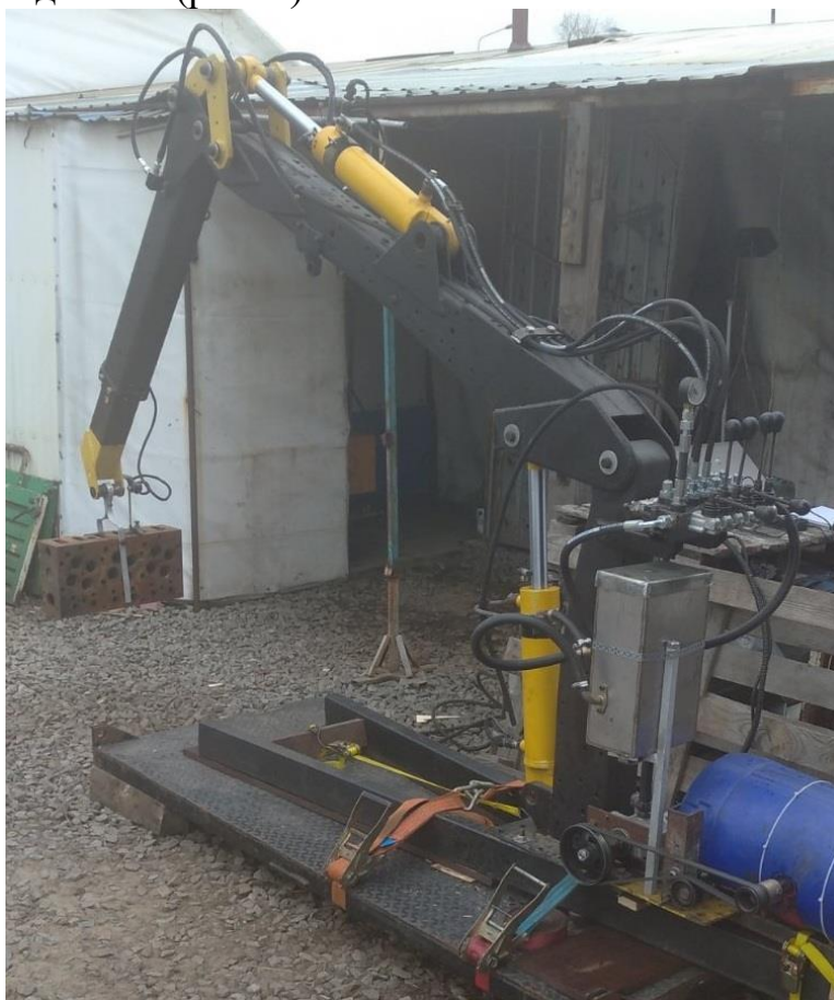
Рис. 1. Експериментальна установка крана-маніпулятора з гідроприводом
