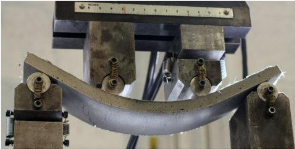
Рис. 4 Випробування зразка плитної конструкції із наномодифікованого бетону
