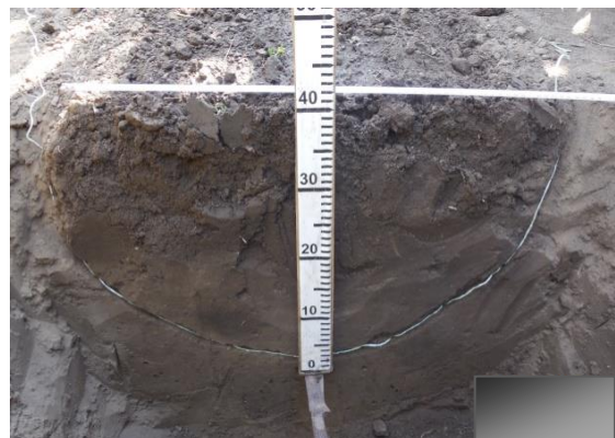
Рис. 1. Фактична зона зволоження середньосуглинкового ґрунту при розміщенні поливних трубопроводів (ПТ) через 70 см
