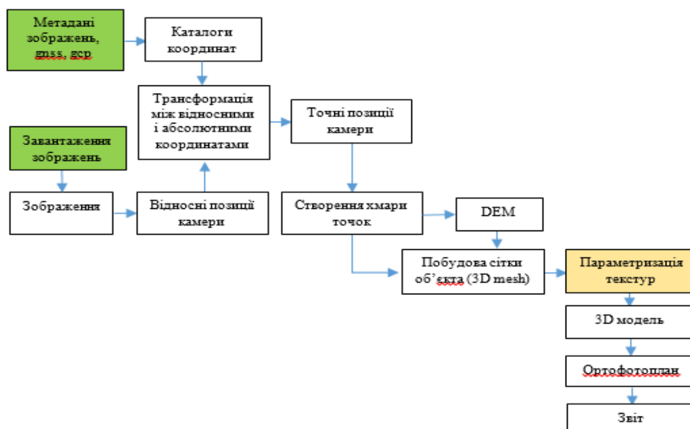
Рис.1. Технологічна схема опрацювання знімків в програмі ODM
