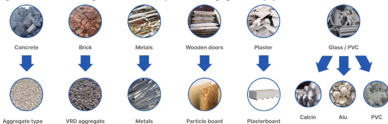
Рисунок 1 – Схема переробки будівельного сміття на нові матеріали [3].
