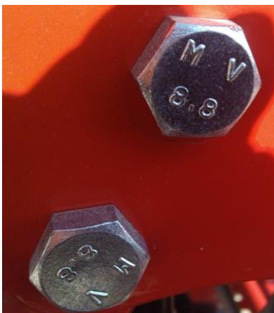
Рис. 1. Клас міцності болтів на сівалках випуску 2013 року.
