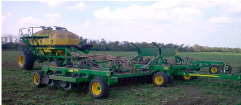
Рис. 1. Комбінований посівний машинно-тракторний агрегат John Deere 8345R + John Deere 1890+ John Deere 1910.
