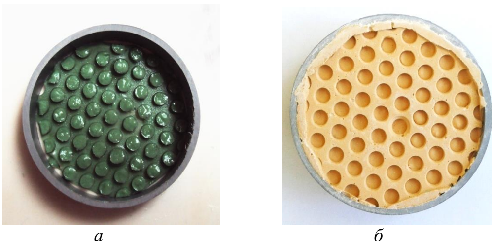
Рис. 1. а – встановлення зліпка у форму; б – утворена форма частини решета.
