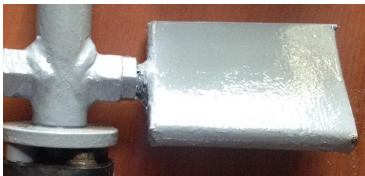
Рис. 3.4. Зовнішній вигляд кріплення лопатей до порожнистого валу електротепломеханічної системи
