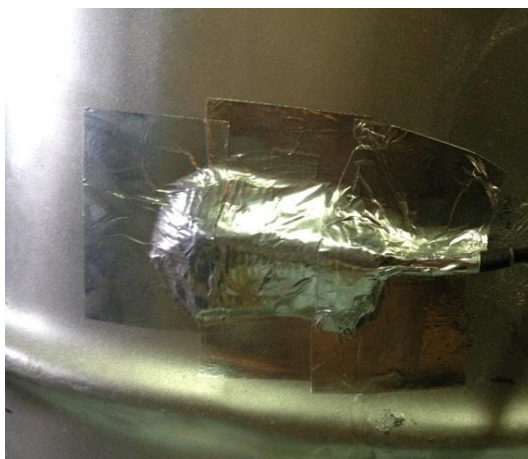
Рис. 3.11. Місце встановлення вологозахищеного датчика температури на стінці біогазового реактора DS18B20
