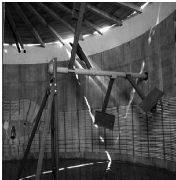
Рис. 1.18. Лопатева мішалка [78]: 1– лопаті ; 2 – вал; 3 – накладка; 4 – шпонка; 5 – підп'ятник; 6 – зубчаста передача
