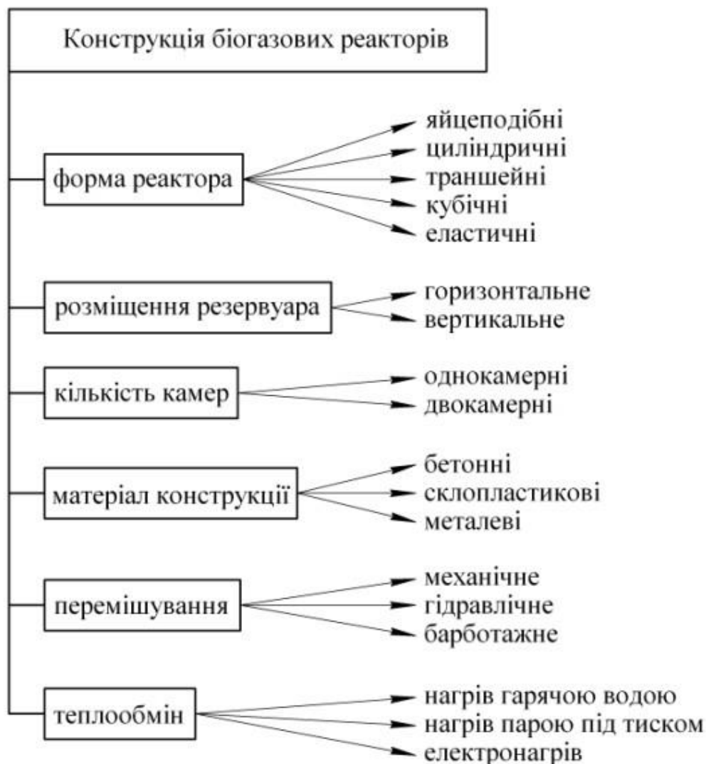
Рис 1.5. Класифікація біогазових резервуарів за конструктивними ознаками
