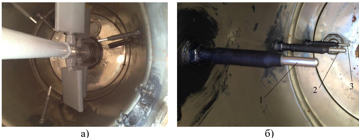
Рис. 3.14. Місце встановлення датчиків температури у об'ємі субстрату, а) яруси вимірювальних датчиків у об'ємі реактора; б) позначення ярусів вимірювальних датчиків температури: 1 – верхній ярус, 2 – середній ярус, 3 – нижній ярус.
