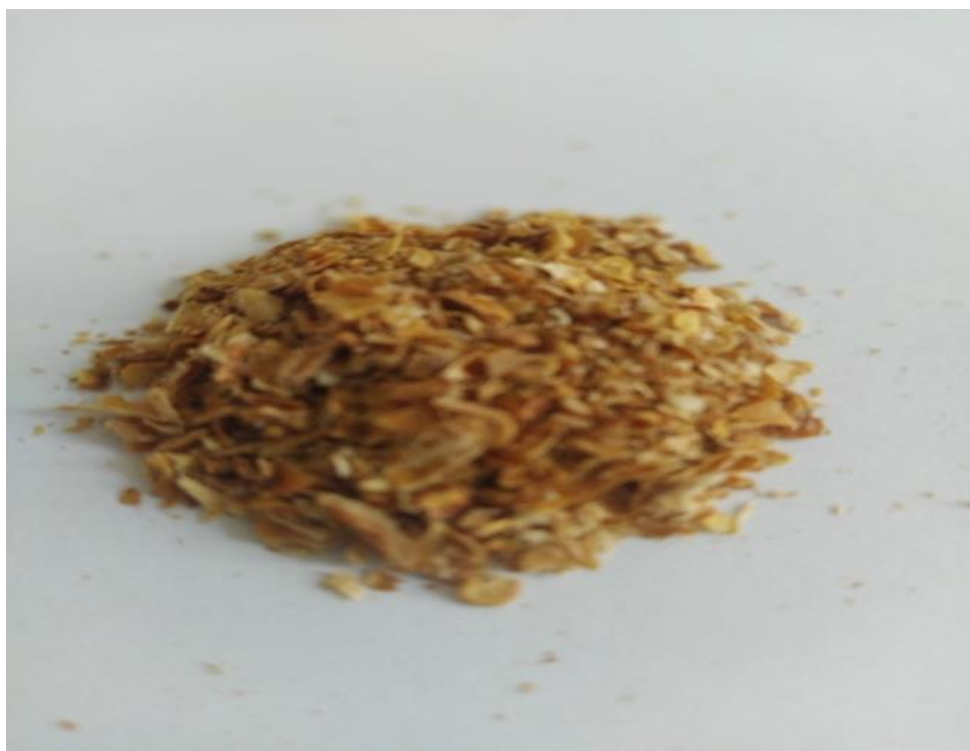
Рис. 5.14. Зовнішній вигляд щільного залишку після екстрагування ЛКК і КФК з головогрудей чорноморської трав'яної креветки
