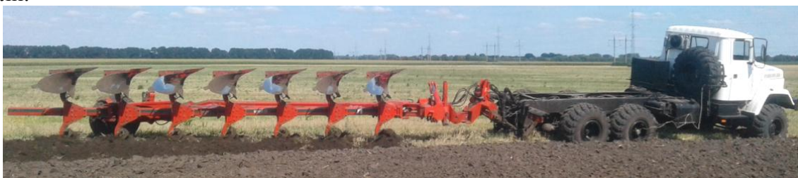
Рис. 1. Пахотный агрегат МЭС-330 + плуг Hektor-1000
