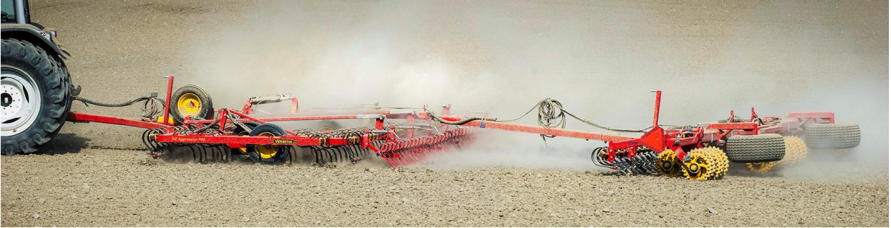
Рис. 8. Культиватор NZ Aggressive + коток Rollex або Rexius для прикочування ґрунту
