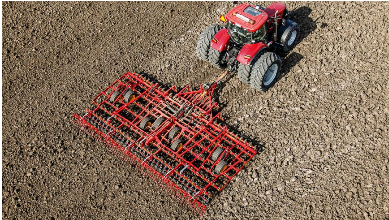
Рис. 6. Шахове розміщення транспортних коліс на NZ Aggressive
