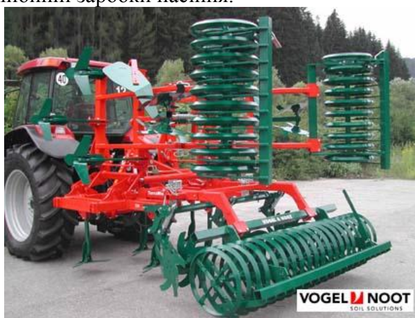
Рис. 2. Комбінована машина VN Terra Mix 500 Hydro для передпосівного обробітку ґрунту
