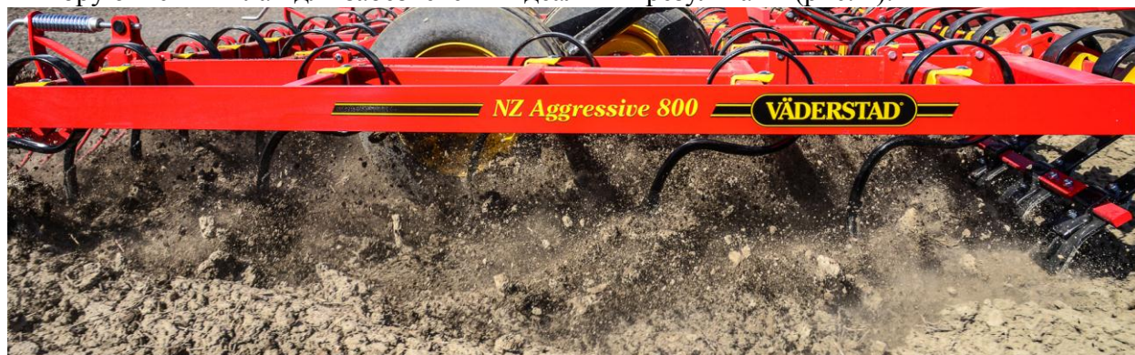
Рис. 2. Вібруючі стійки лап AgrillaCobra на NZ Aggressive
