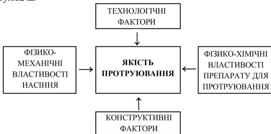
Рис. 1. Фактори, що впливають на якість протруювання насіння
