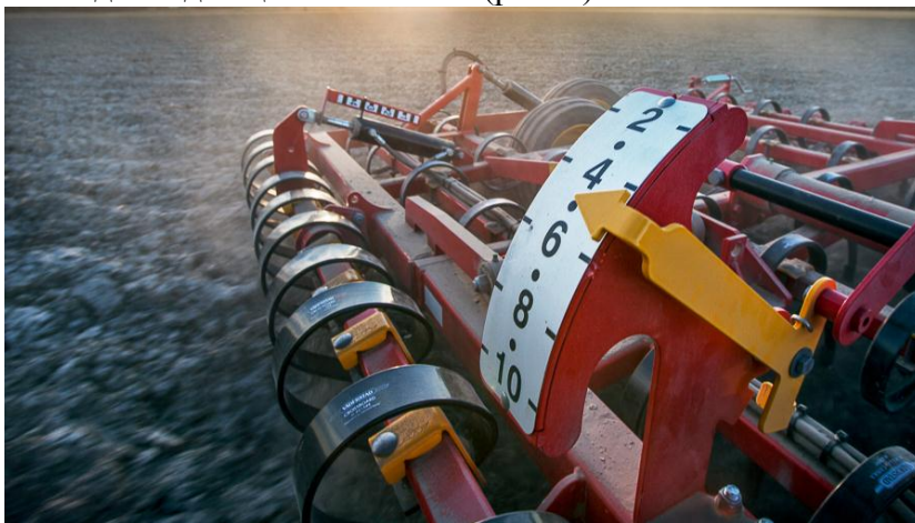
Рис. 1. Управління контролю глибини ControlFunction на NZ Aggressive
