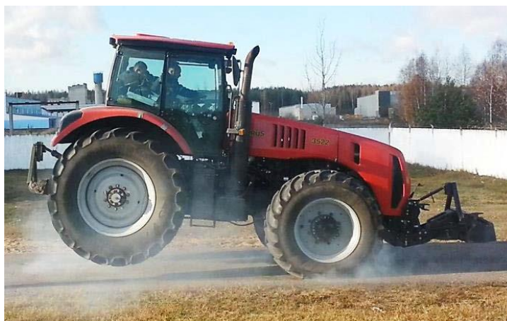
Рисунок 1 - Потеря устойчивости машины на режиме экстренного торможения при прямолинейном движении трактора
