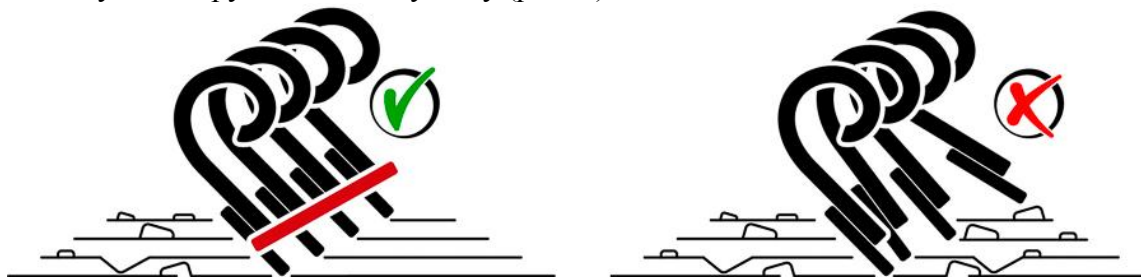
Рис. 4. Стабілізуючий брус CrossBoard на NZ Aggressive
