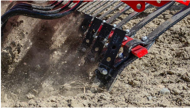
Рис. 5. Одинарний ніж SingleKnife на NZ Aggressive
