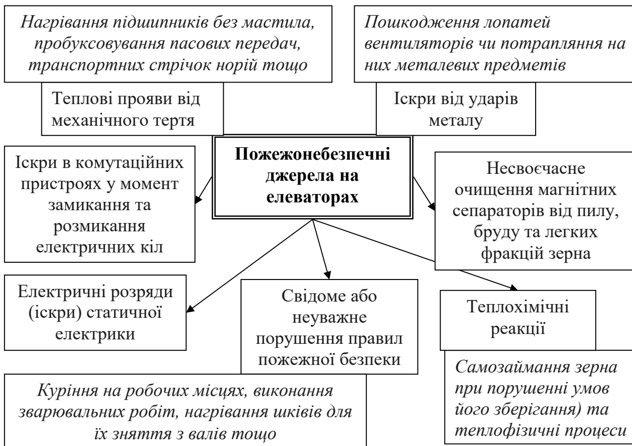
Рис. 1. Потенційні пожежеонебезпечні джерела у виробничих приміщеннях елеватора
