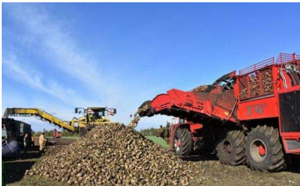
Рис. 1. Перевалочна технологія збирання цукрового буряка з використанням комплексу сучасних високопродуктивних збирально-транспортних засобів
