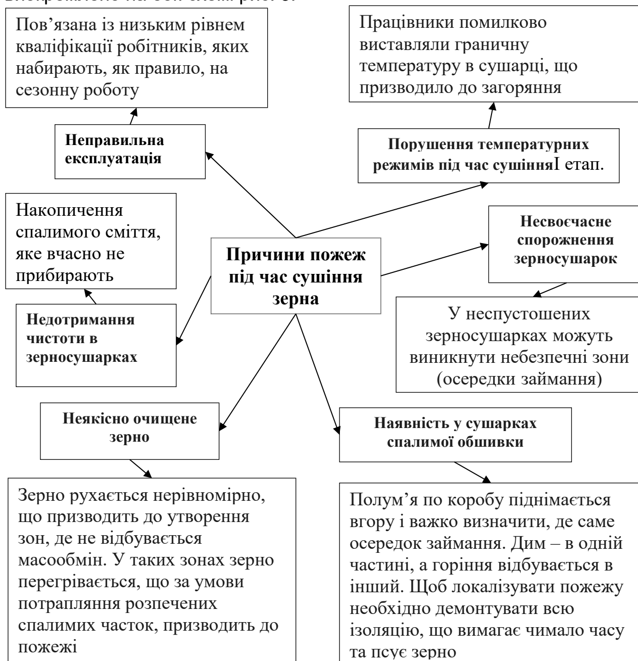
Рис. 3. Виокремлення причин вибухів і пожеж у зернових сушарках
