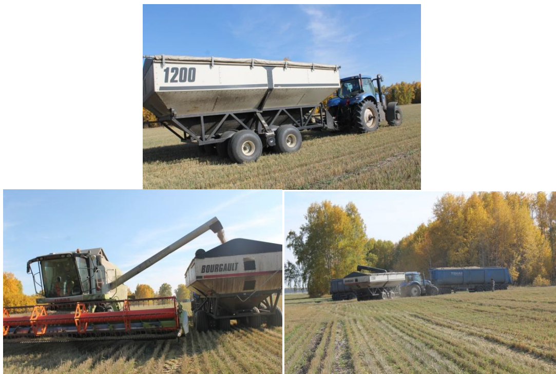
Рис. 1 – Перевантажувальна технологія з використанням причепів-перевантажувачів.
