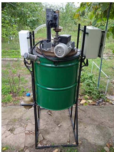
Рис. 2. Зовнішній вигляд експериментальної біогазової електротепломеханічної системи установки
