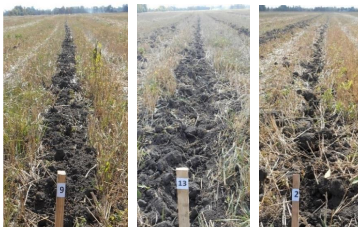
Рис. 1. Фото зразків візуальної оцінки досліджень впливу глибини обробітку глибокорозпушувачем H , відстані між відрізними дисками B та швидкості руху агрегату V .
