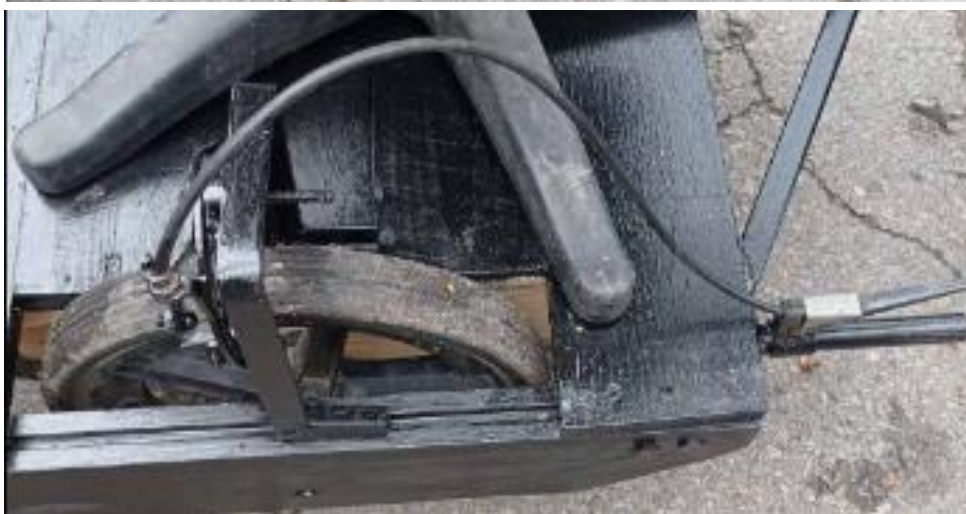
Рис. 2. Елементи конструкції AiTC-2: а) модуль А – рама, мотор-колесо, бокс для тягової батареї, підніжки, причіпний пристрій; б) елементи гальмівної системи, змонтовані на модулі Б.
