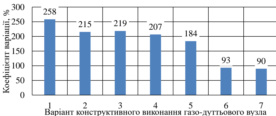
Рис. 1. Залежність коефіцієнту варіації від номеру конструктивного виконання газо-дутьового вузла газогенератора
