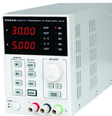
Рис. 3. Лінійний лабораторний блок живлення KORAD KA3010D.
