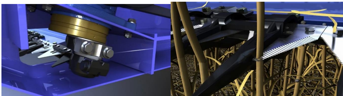
Рис. 1. Модель різального апарату сегментно-пальцевого типу з використанням протирізальних пальців Шумахера.
