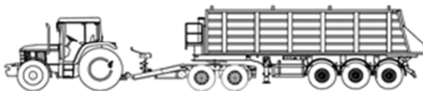
Рис. 1 Схема тракторного автопоїзда з ПСП-20
