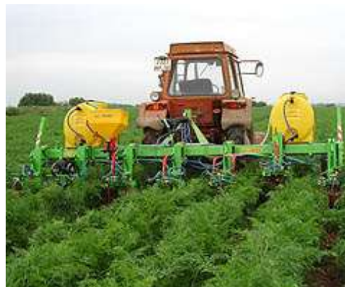
Рисунок 2 – Підкормлювач: а – підкормлювач ПЖУ–2,5; б – начіпний культиватор KL 4,2
