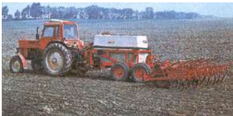
Рисунок 2 – Підкормлювач: а – підкормлювач ПЖУ–2,5; б – начіпний культиватор KL 4,2
