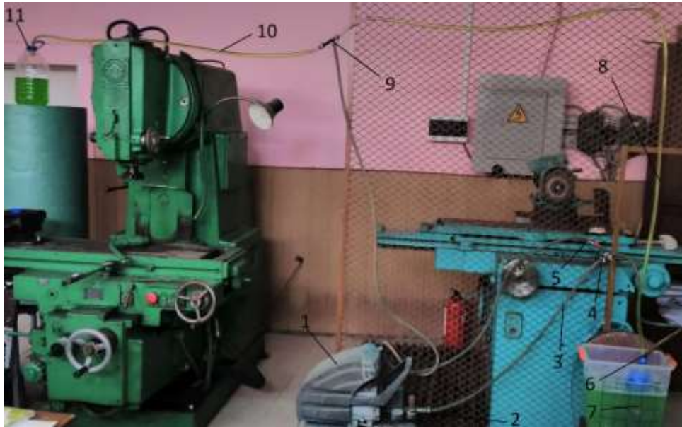
Рисунок 1– Фото лабораторної установки для дослідження процесу добування та транспортування сапропелю: 1 – компресор; 2 – регулятор тиску подачі повітря; 3 – головний повітропровід; 4 – розгалужувач; 5 – вентиль; 6 – забірний пристрій; 7 – ємкість; 8 – підймальний трубопровід; 9 – змішувач; 10 – транспортуючий трубопровід; 11 – мірна посудина
