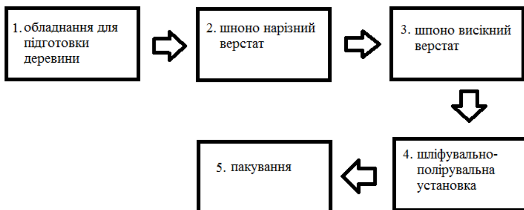
Рис. 1. Послідовність технологічного процесу виготовлення виробів зі шпону
