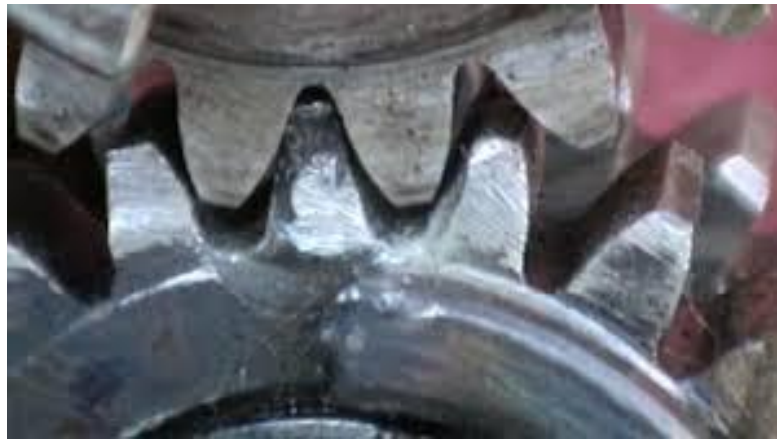
Рис. 1. Прогресуюче викришування зубів зубчастої передачі
