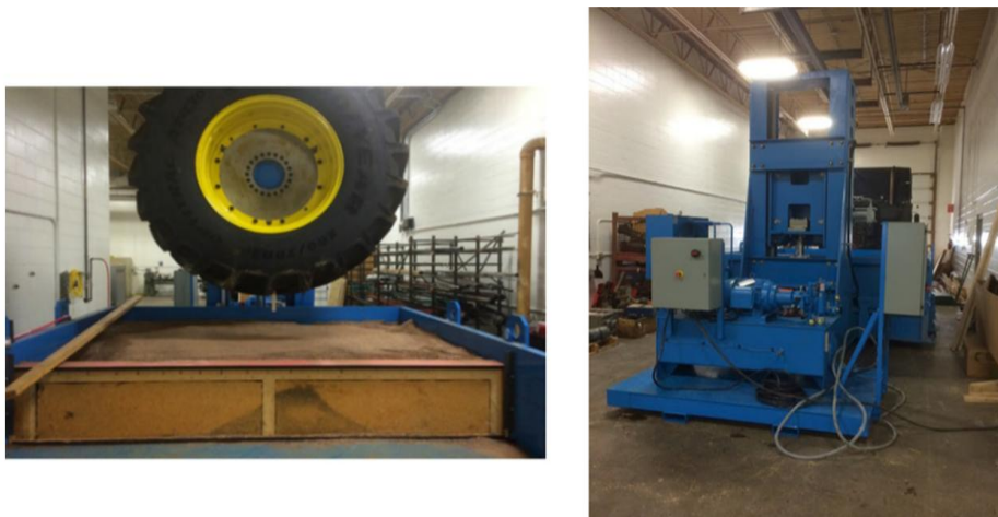
Рис. 3. Система статичного навантаження колеса
