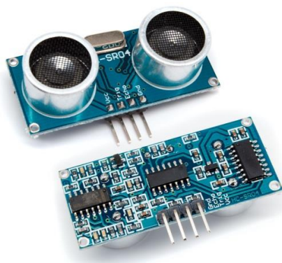
Рисунок 1. Ультразвуковий далекомір HC-SR04
