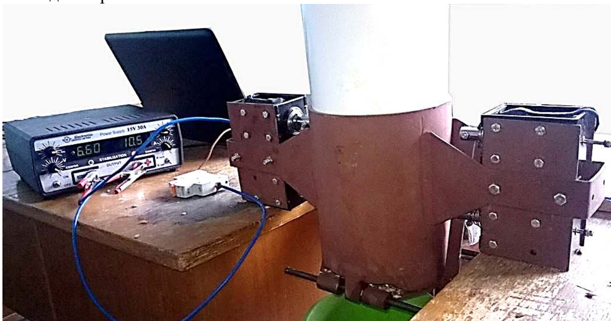
Рисунок 1 – Загальний вигляд експериментального зразка дозатора комбікормів
