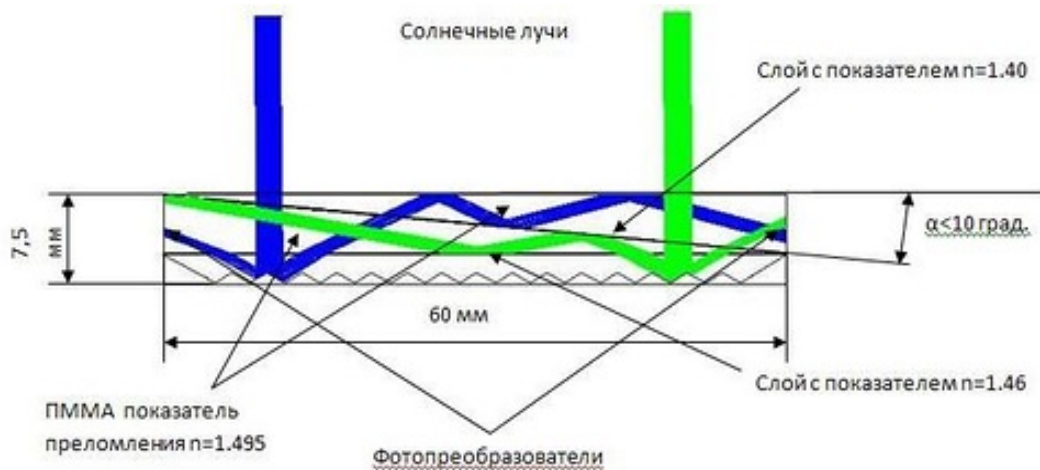
Рис. 1. Схема концентратора PlanarSun (запозичене з роботи [2]).
