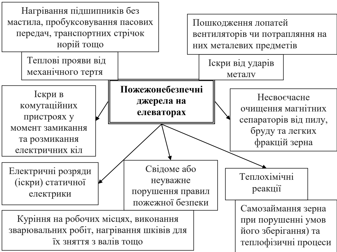
Рис. 1. Потенційні пожежонебезпечні джерела у виробничих приміщеннях елеватора.
