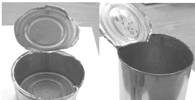
Рис.1. Жерстяні банки досліджуваних проб м'ясних консервів з темними плямами на стінках та відшаруванням лакового покриття
