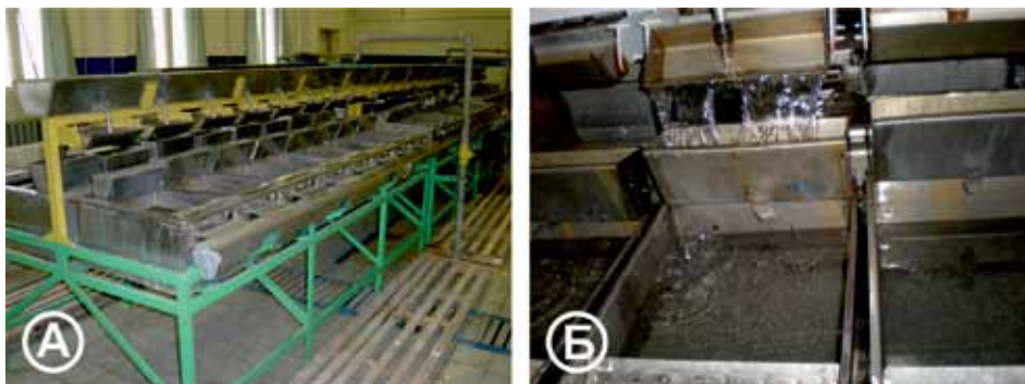
Рисунок 75: Инкубационный аппарат «Осетр»: А – одна из сторон аппарата, Б – инкубационные ящики аппарата «Осетр» в период инкубации икры белуги.
