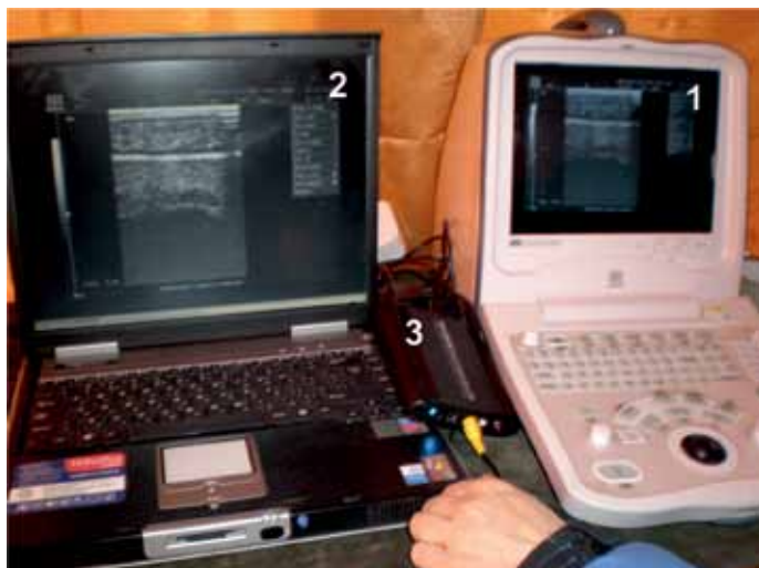
Рисунок 134: Мобильный информационно-аналитический комплекс на основе УЗИ-сканера Mindray DP-6600: 1 – ноутбук; 2 – УЗИ-сканер; 3 – декодер MPEG2.
