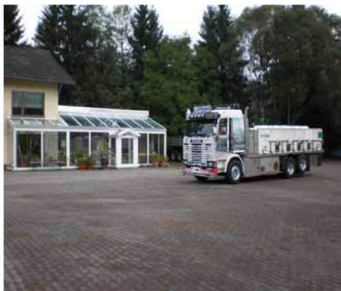
Рисунок 110: Специализированная живорыбная машина с контейнерами, обеспечивающими оптимальные условия транспортировки.
